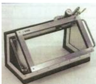
BOITE A VIDE TYPE V400 (Pour soudures d'angle)
