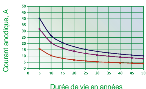
Durée de vie des anodes tubulaires LIDA® dans l'eau douce
