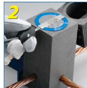
Brancher le connecteur sur la languette d'allumage
